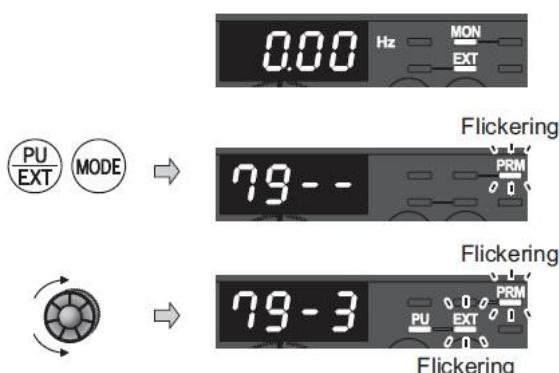
Inverter'e enerji verildiğinde parametre ünitesi üzerindeki display ve led durumu soldaki gibidir.
