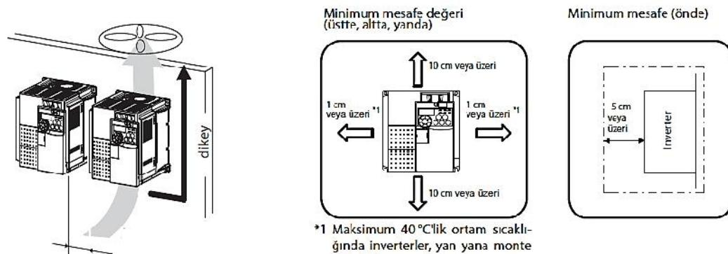
Inverter çok hassas mekanik ve elektronik parçalardan oluşur, asla aşağıda gösterilmiş şartlarda montaj yapmayınız ve çalıştırımayınız
